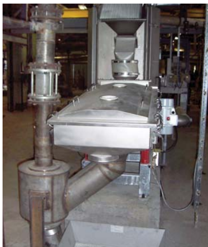
Аэробачок — конструкторское решение специалистов ПКО ОАО «Могилевхимволокно» — изменил метод отбора полимера после вибросита и позволил задействовать существующую систему пневмотранспорта.
